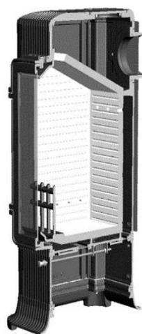
Футеровка (вермикулит) и ограждение-гребень из чугуна
